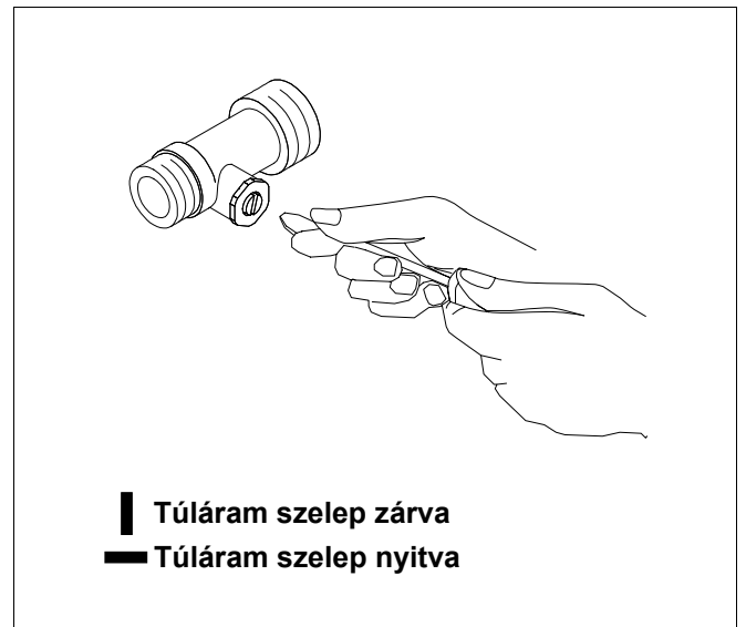
24. ábra A túláram szelep beállítása
